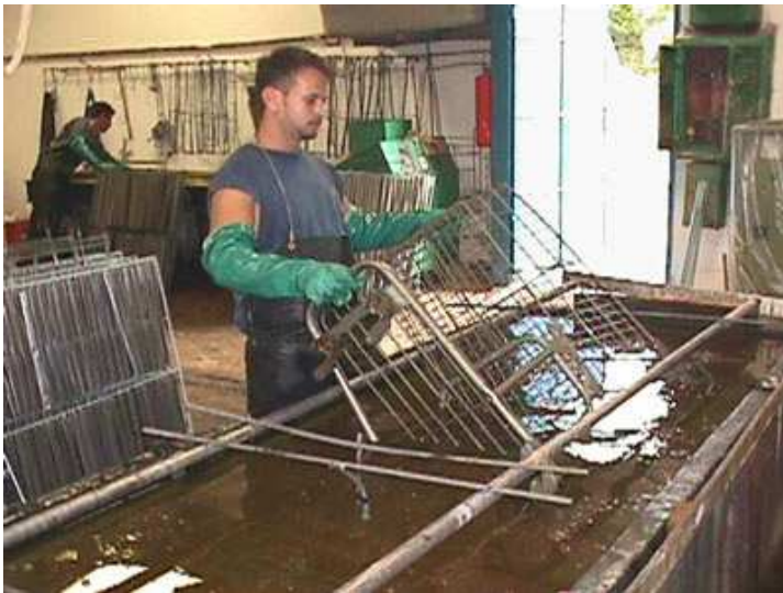
Figura 9 - Exemplo de banho eletrolítico manual e respectivo produto final Fonte: GALVOATA
