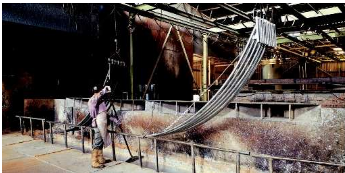
Figura 6 - Galvanização por imersão a quente Fonte: SANTA CLARA
