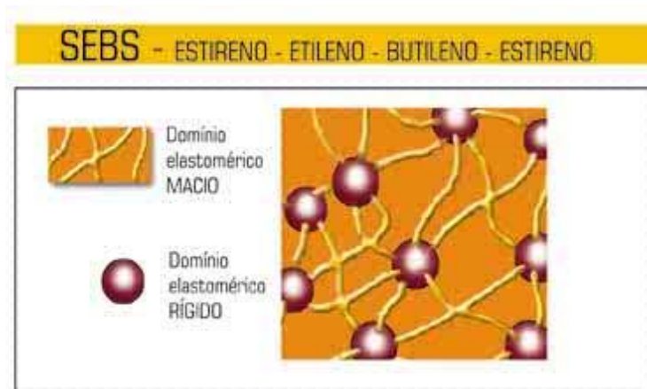
Figura 2 - Representação esquemática da estrutura do SEBS. Fonte: Plástico, 2007.
