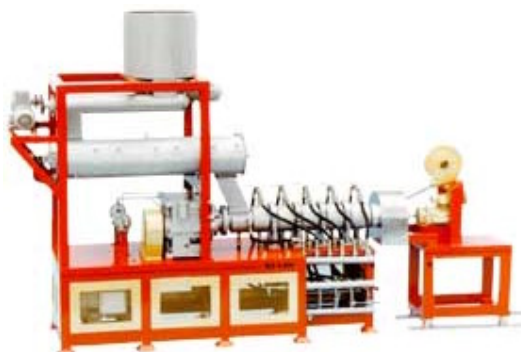
Figura. 10. Equipamento compacto para produção de ração animal Fonte: Inbramaq – Tecnologia em Extrusão de Cereais
