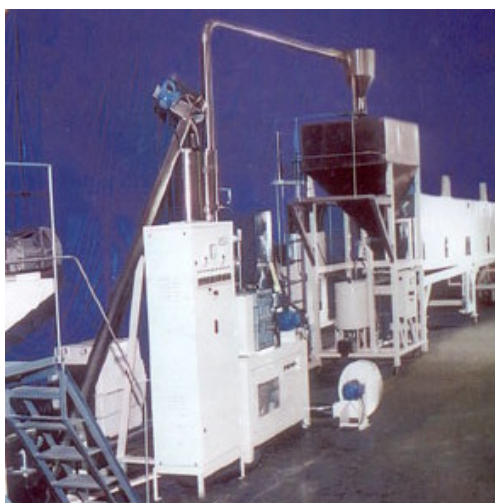
Figura 7. Estrusora para produção de cereais matinais (capacidade 110/140 kg/hora) Fonte: Inbramaq – Tecnologia em Extrusão de Cereais
