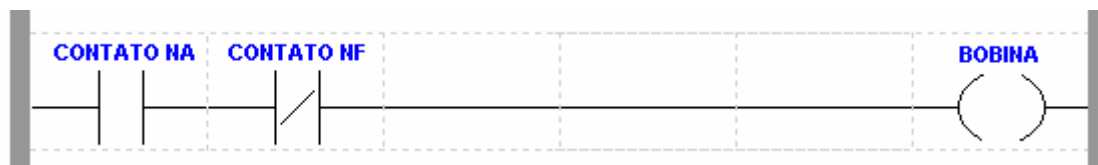
Figura 17 – Elementos básicos da Linguagem Ladder Fonte: Centro Tecnológico de Mecatrônica SENAI, 2007.
