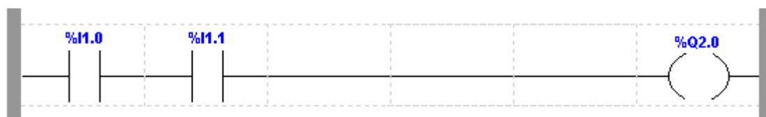
Figura 18 – Lógica “E” Fonte: Centro Tecnológico de Mecatrônica SENAI, 2007.
