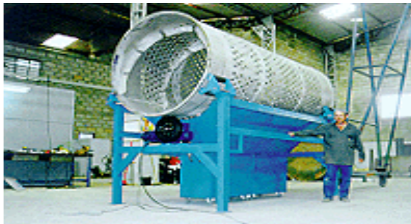
Fig.16 Tumbladores em aço inox para retirada de contaminações grosseiras para linha de revalorização de plástico Disponível em: < http://www.krown.com.br/equipamentos.htm >
