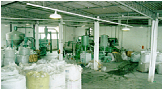
Fig. 15 Linha de revalorização de PET de 250 a 1.200Kg/h Disponível em: < http://www.krown.com.br/equipamentos.htm >
