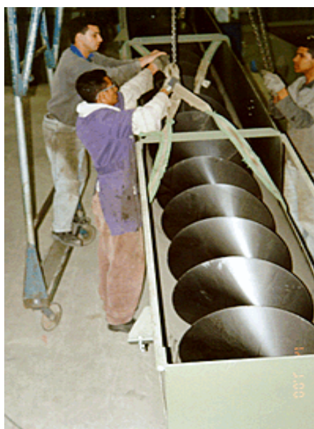
Fig.13 Roscas transportadoras helicoidais de diversas capacidades em carbono inox Disponível em: < http://www.krown.com.br/equipamentos.htm >
