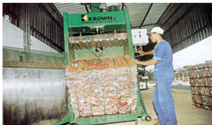
Fig.17 Prensas hidráulicas verticais de 8, 12, 20 toneladas para enfardamento de plástico, papel, etc. Disponível em: < http://www.krown.com.br/equipamentos.htm >
