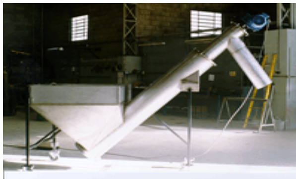
Fig. 12 Sistema de separação de líquidos por roscas duplo envelope. Silos com roscas homogeneizadoras Disponível em: < http://www.krown.com.br/equipamentos.htm >
