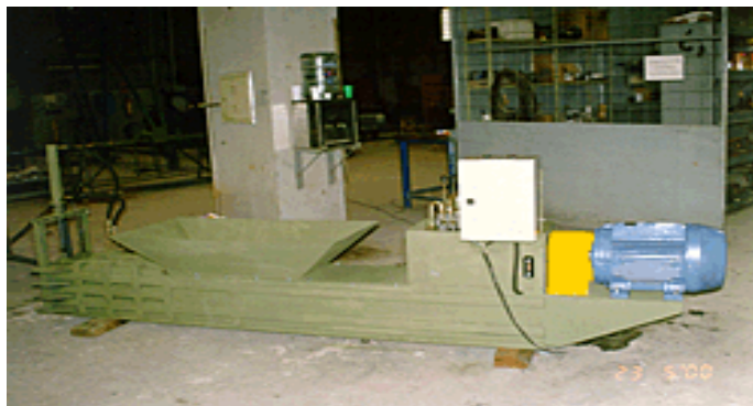
Fig.18 Pressas hidráulicas horizontais de 30, 40, 50 toneladas para enfardamento de alumínio, ferro, aço, etc.
