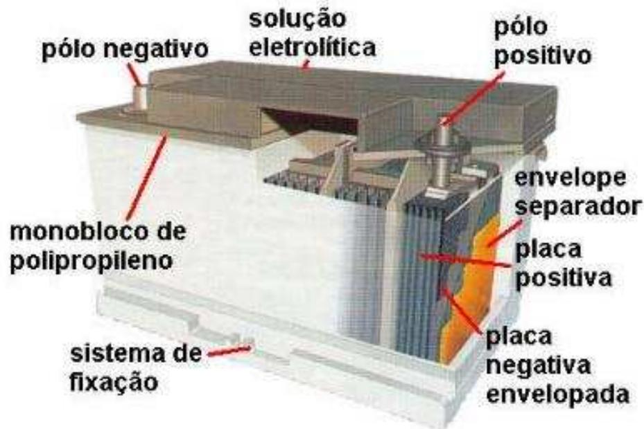
Figura 11 - Componentes de baterias veiculares
