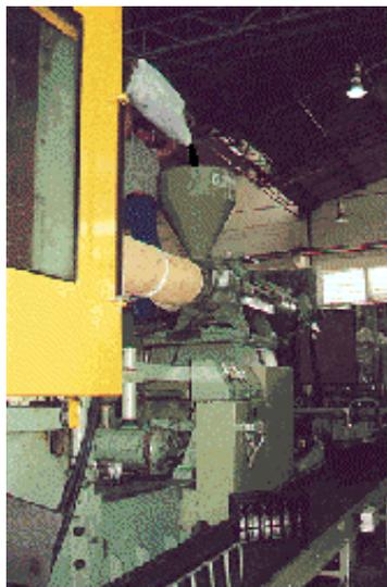
Figura 29 - Reutilização do plástico na produção de caixa e tampa de novas baterias
