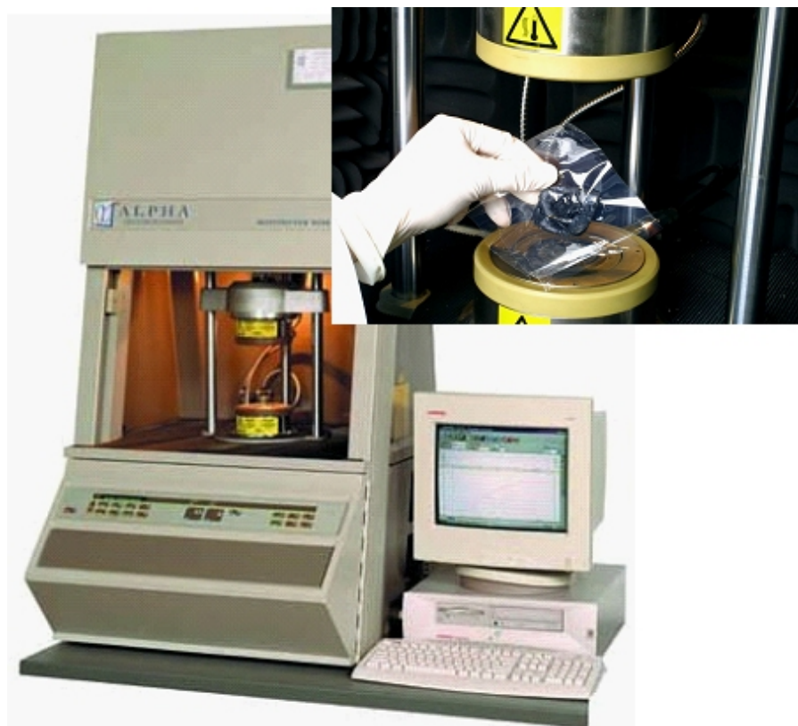
Figura 3 - Equipamento reômetro MDR. No detalhe, o corpo-de-prova do MR sendo inserido no equipamento para avaliação.
