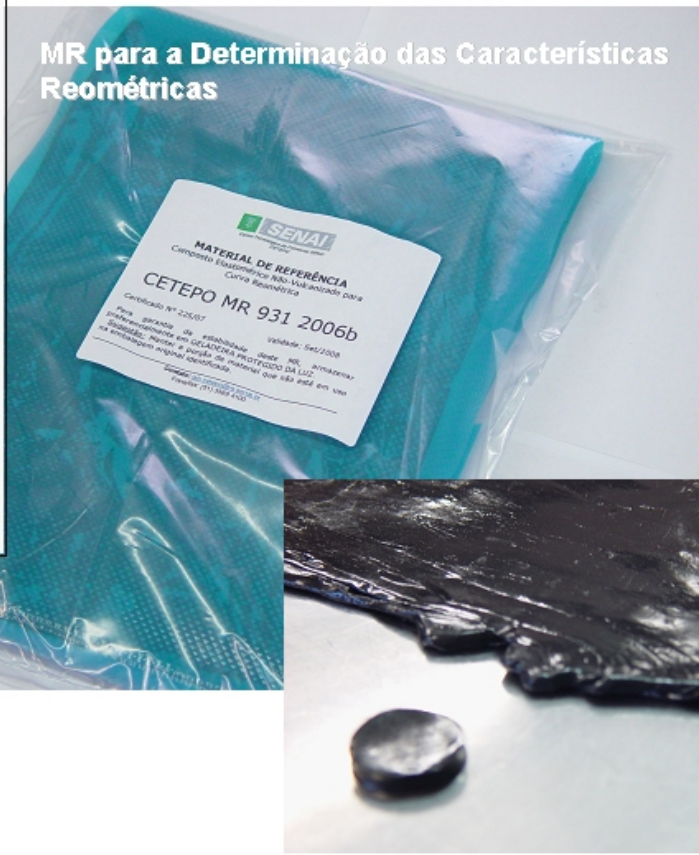
Figura 2 - Material de referência para o ensaio de reometria MDR. No detalhe, a esquerda, o certificado de análise e a direita o corpo-de-prova obtido do MR laminado, a base de borracha silicone. Fonte: SENAI – Centro Tecnológico de Polímeros, 2007.
