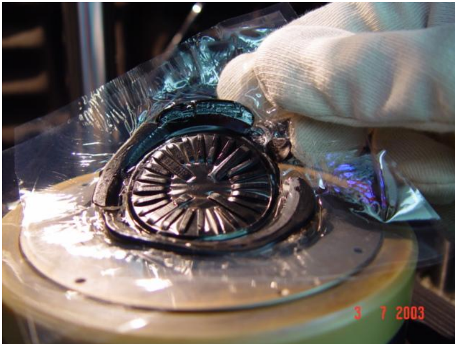
Figura 3 - Composto elastomérico não vulcanizado para determinação das características reométricas. Fonte: SENAI - Centro Tecnológico de Polímeros, 2007.
