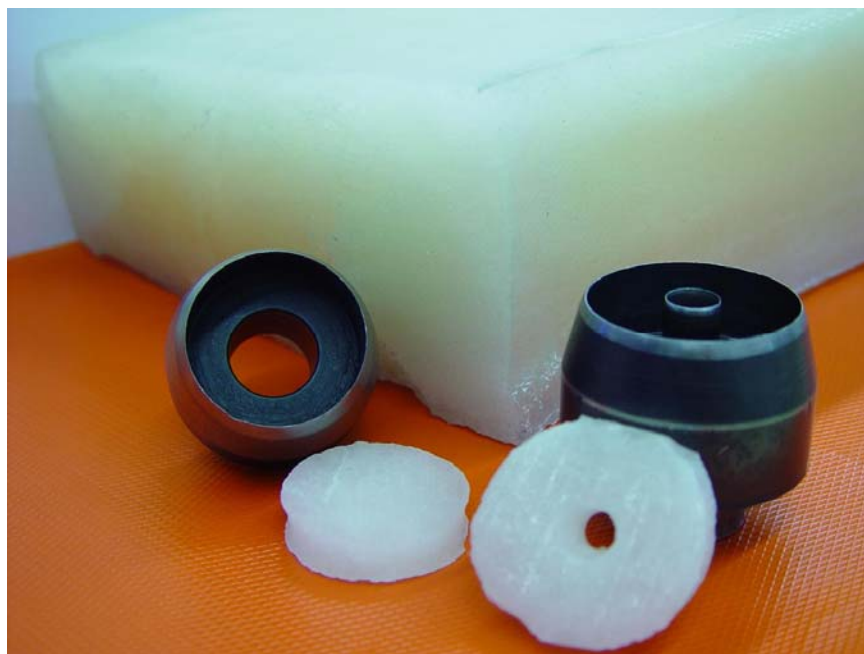
Figura 2 - Elastômero para Determinação da Viscosidade Mooney. Fonte: SENAI - Centro Tecnológico de Polímeros, 2007.
