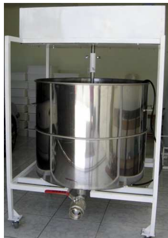
Figura 19 - Reator misturador em aço inox Fonte: FENOQUÍMICA
