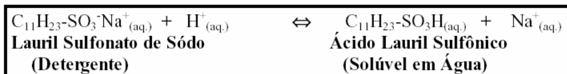
Figura 4 - Reação entre um detergente tipo lauril sulfonato de sódio quando em águas ácidas
