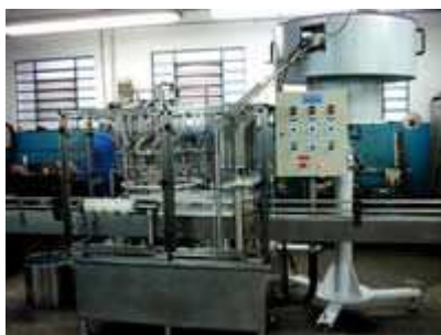
Figura 20 - Máquina automática rotativa com 20 bicos Fonte: EDWARD
