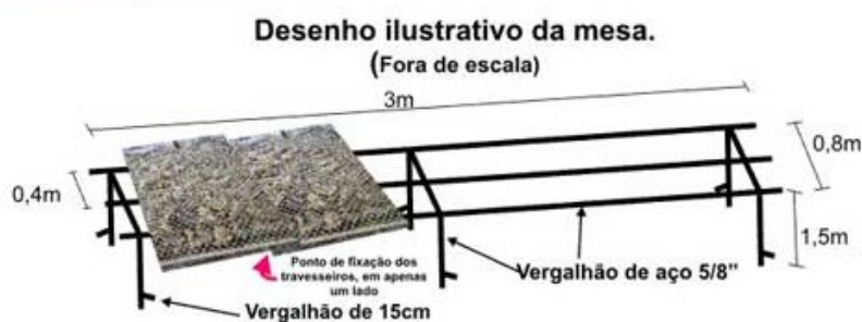
Figura 13: Mesa para cultivo de ostras em travesseiros Fonte: ENGEPECA, [199?]
