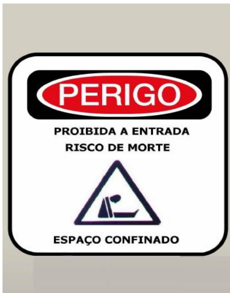
Figura 4 – Sinalização para identificação de espaço confinado Fonte: (BRASIL, 2006)
