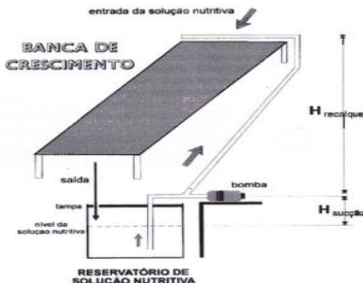
Figura 4 - Esquema de um sistema hidráulico Fonte: (SILVA; MELO, [200-?])
