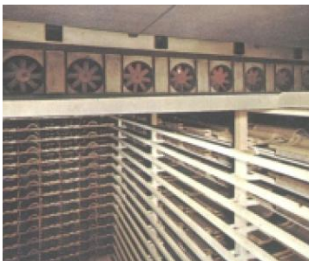
Figura 9 – Exemplo de secador de peças de cerâmica vermelha tipo câmara Fonte: (GRICOLETTI, 2001)
