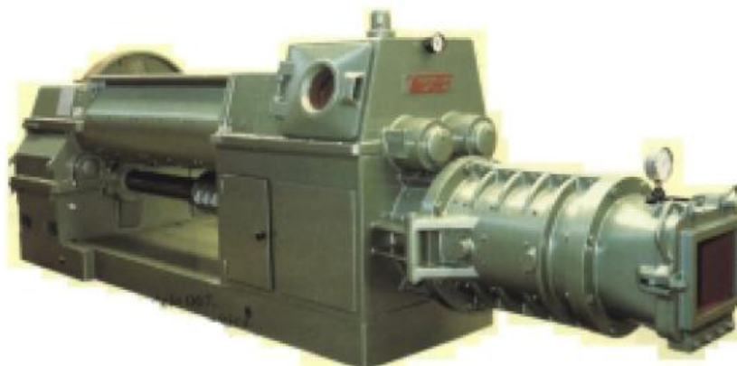
Figura 7 – Máquina para moldagens de peças de cerâmica vermelha (extrusora ou maromba) Fonte: (GRICOLETTI, 2001)
