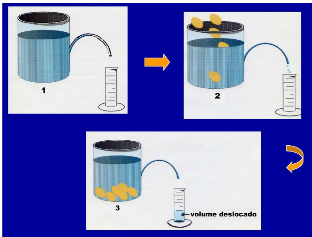
Figura 3 Esquema para determinação do teor de sólidos solúveis totais (quantidade de matéria seca) da batata.
