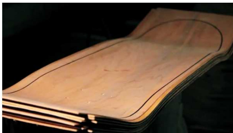
Figura 26 – Modelo marcado na madeira Fonte: (HUGUES, 2010)
