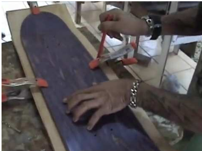
Figura 25 – Marcação do modelo com gabarito Fonte: (MY SKATEBOARD, 2011)
