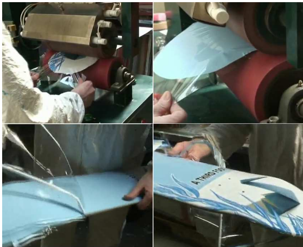
Figura 36 – Aplicação de transfer para decoração do shape Fonte: (CLUBE DO SKATE, 2011)
