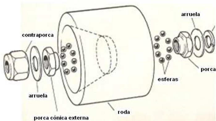
Figura 12 – Desenho esquemático dos rolamentos e roda Fonte: (TASSARA, 2009)
