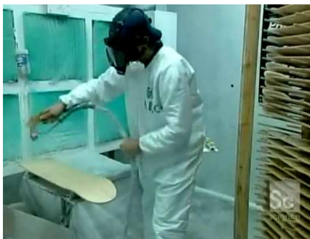
Figura 32 – Aplicação de selante na madeira Fonte: (SCIENCE CHANNEL'S, [2009])
