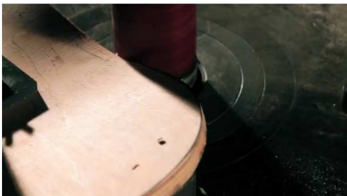
Figura 28 – Aplainamento das bordas do shape Fonte: (HUGUES, 2010)
