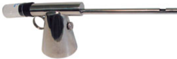
Figura 15: Pistola para teste de Alizarol. Disponível em: < www.hexasystems.com.br >.
