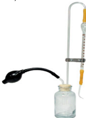
FIG 8. Acidímetro de Dornic para análise de acidez. Disponível em: < www.cap-lab.com.br/2004/images >.
