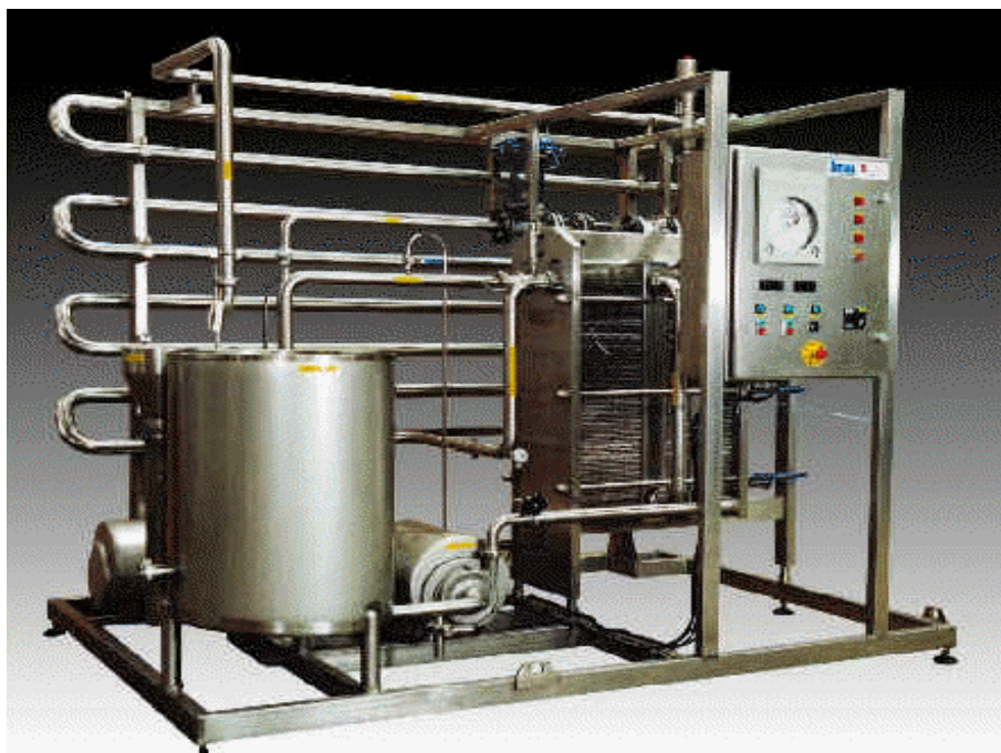
FIG 2. Pasteurizador a placas. Disponível em < www.dantherm.com.br >.
