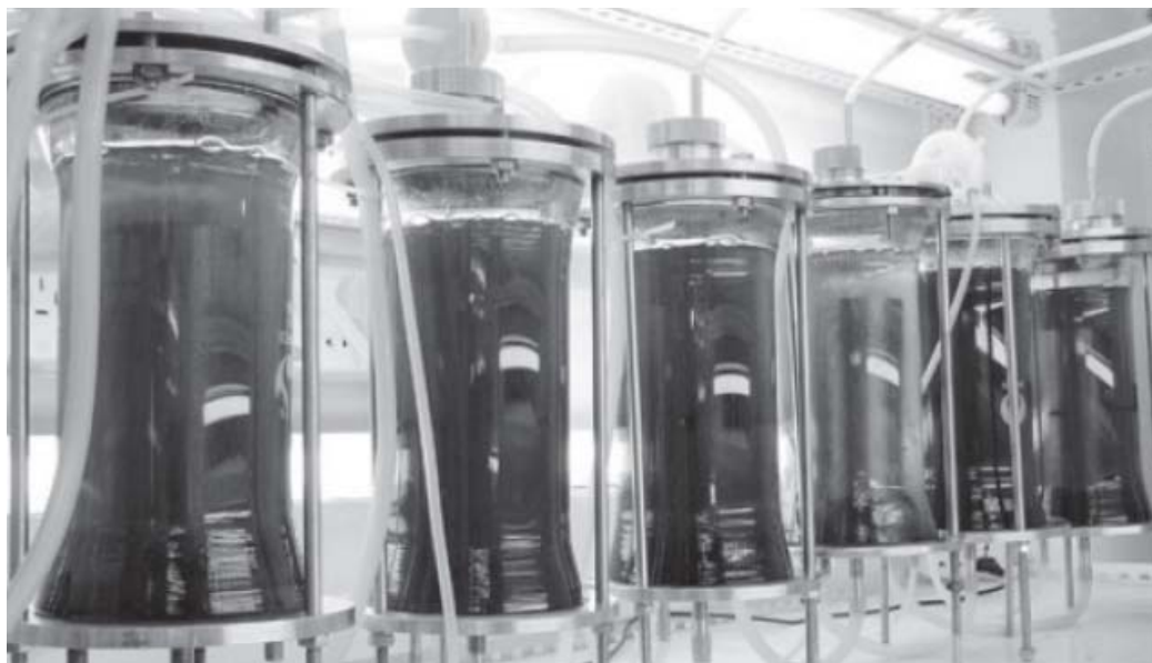
Figura 8 – Biorreatores do tipo airlift , com uma cultura de microalgas crescendo em seu interior Fonte: (MENNA, 2010)
