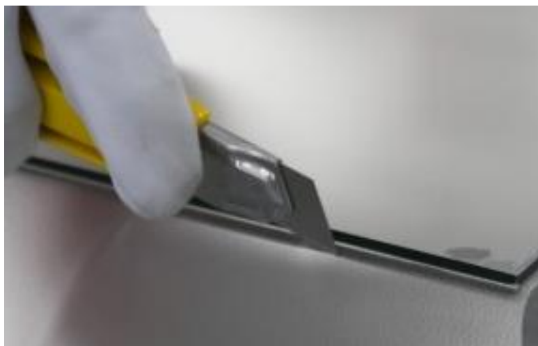
Figura 2 – Corte da película PVB por meio de estilete. Fonte: (ABRAVIDRO, 2018).
