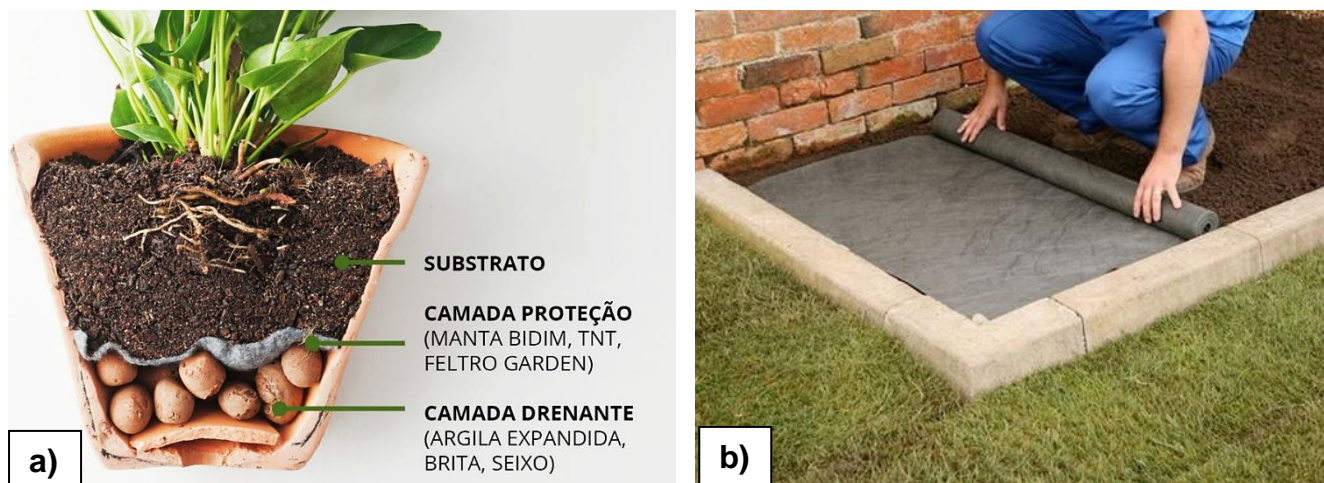
Figura 2 – Exemplo da utilização do feltro como manta de drenagem em a) vasos e b) grandes jardins.
