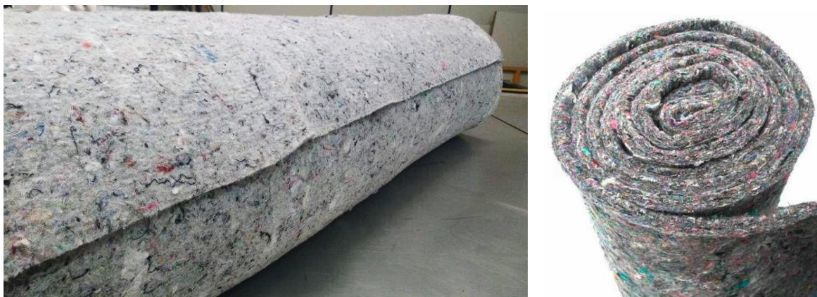
Figura 1 – Feltro automotivo com fibras agregadas por calandragem (processo de conformação de materiais através de cilindros aquecidos).
