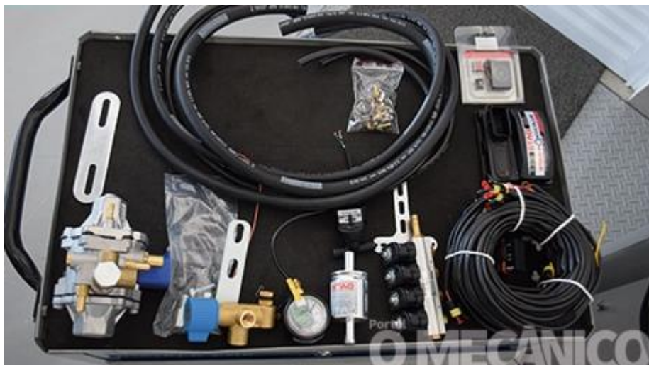
Figura 2 – Peças pré-montagem GNV da parte dianteira Fonte: (BASSETI; LIMA; SÁ, 2019)
