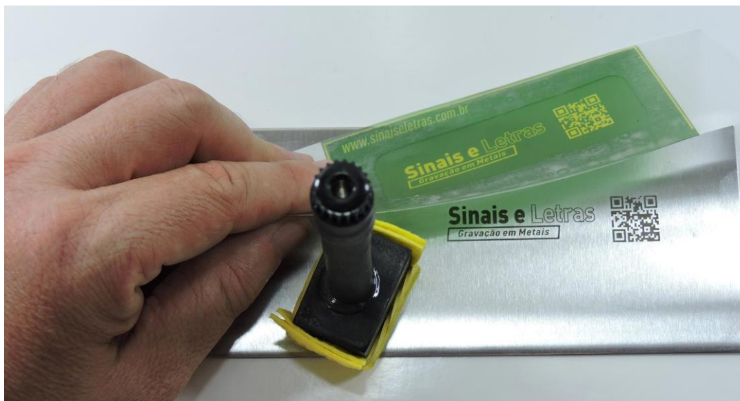
Figura 1: Gravação eletroquímica escura em aço inox 304 com a utilização de estêncil e cabeçote gravador.
